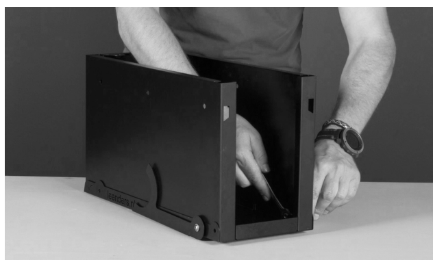
Voorpootjes 6 monteren (2x bout + 2x borgmoer). Borgmoeren niet te strak aandraaien, pootjes moeten kunnen bewegen.
