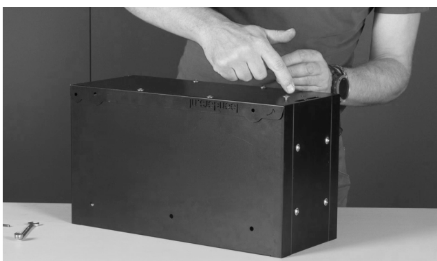
Ook aan bodemplaat monteren (2x bout).
