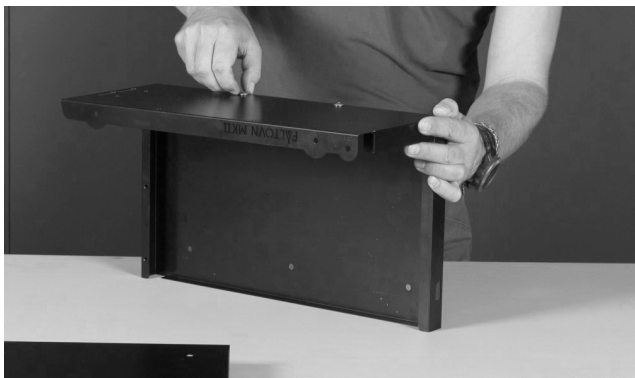
Bodemplaat 1 aan linker zijplaat 2 monteren (2x bout in bodem). √-teken lijnen.
