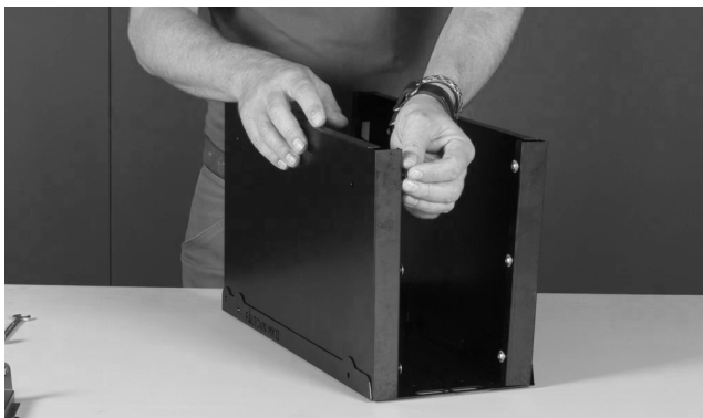
Achterwand 4 monteren. Eerst bouten (6x) in zijwanden draaien, niet aandraaien. Vervolgens achterwand er in schuiven en bouten (6x) strak aandraaien.
