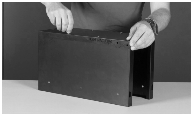
Rechter zijplaat 3 aan bodemplaat monteren (2x bout in bodem).
