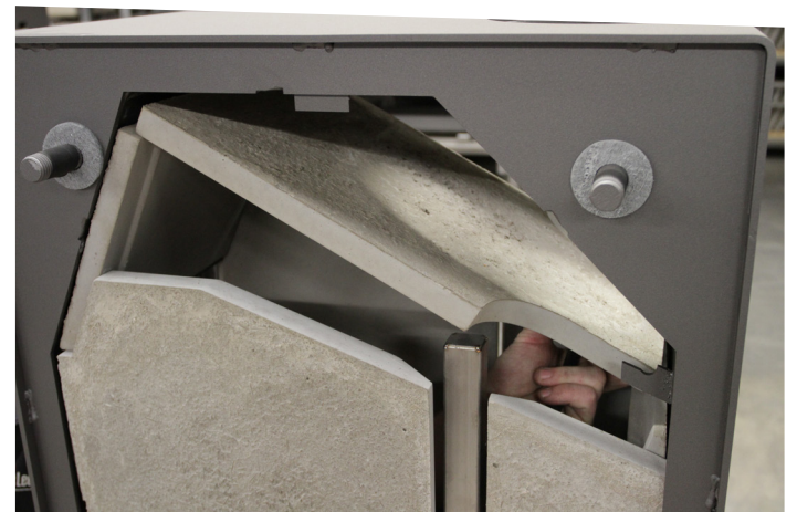
...of verwijder het bovenste hiteschild door de stang waarop het bovenste hiteschild rust en kantel de achterzijde zodat het veegsel in de kachel valt.
