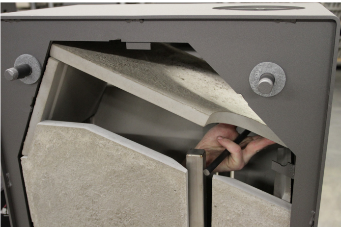
...of verwijder het bovenste hiteschild door de stang waarop het bovenste hiteschild rust en kantel de achterzijde zodat het veegsel in de kachel valt.
