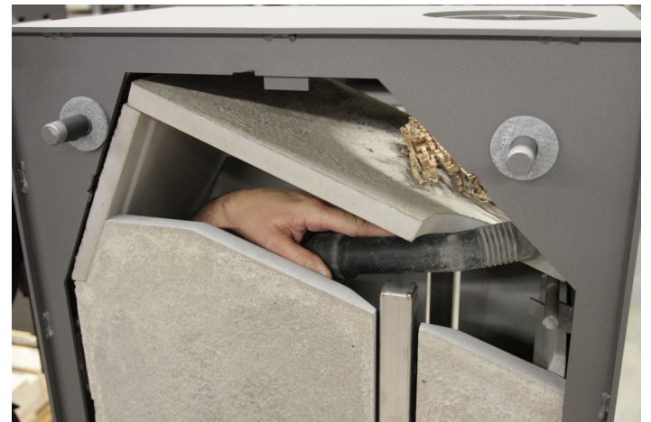
Gebruik een stofzuiger (die aan staat en dan het liefste de slang en niet de stofzuiger zelf, want dat past niet) om roetresten van het bovenste hiteschild te zuigen...
