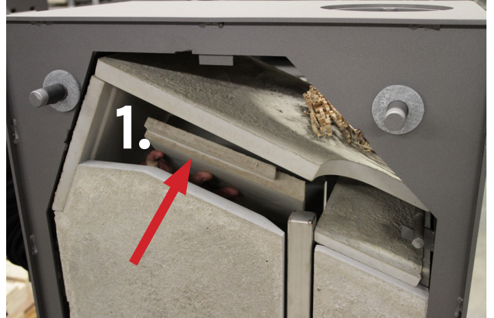
Verwijder de twee onderste hiteschilden (1. en 2.) door ze te kantelen. Pas op voor beschadigen.
